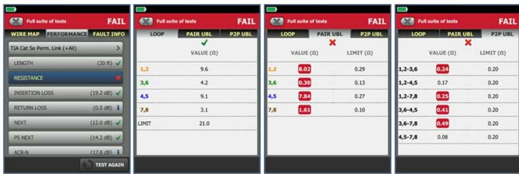
ANSI/TIA 1152 のフィールド・テスト規格には、直流抵抗アンバランスが盛り込まれました。リミット値は ANSI/TIA -568-C.2 で規定されています。これは認証の必須要件ではありませんが、DSX ケーブルアナライザーなどの優れたケーブル・テスターを使えば、簡単にテストに含めることができます。しかし、これには問題点があります。ISO/IEC 11801 第 2.2 版は、チャネルおよびパーマネント・リンクの直流抵抗アンバランスのテスト・リミット値を規定していますが、ANSI/TIA-568-C.2 ではチャネルのテスト・リミット値しか規定されていません。
