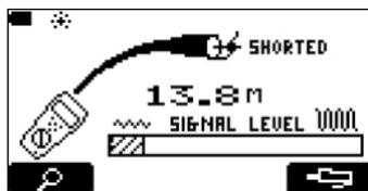
図 2. 長さを測定し、継続性を確認し、短絡および破損への距離を測定します。
