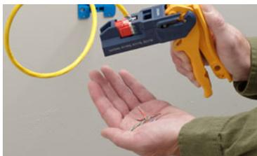
ステップ 7: ハンドルをリリースし、ジャックを JackRapid ツールから取り外します。終端がきちんと完了したかどうか、目で確認してください。
