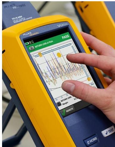
**2. Precision fiber channel information:** With the increasing use of short patch fibers and multi-fiber connectors, details on every link—loss, connector, and reflectance—are critical to ensuring performance. 減衰デッド・ゾーンが 3 m を超える OTDR は、データセンター・ファイバーの試験にもはや適さなくなりました。リンク損失バジェットを大きくしすぎたり、重大な信号劣化を引き起こしたりする問題を検出するには、デッド・ゾーンが非常に短くなっている必要があります。加えて、問題を迅速に解決するには、さまざまなスキル・レベルのユーザーが光ファイバーのトラブルシューティングを効率的に行い、ネットワークをより迅速に復旧させられるよう、故障やイベントをシンプルでグラフィカルな形で表示する必要もあります。
