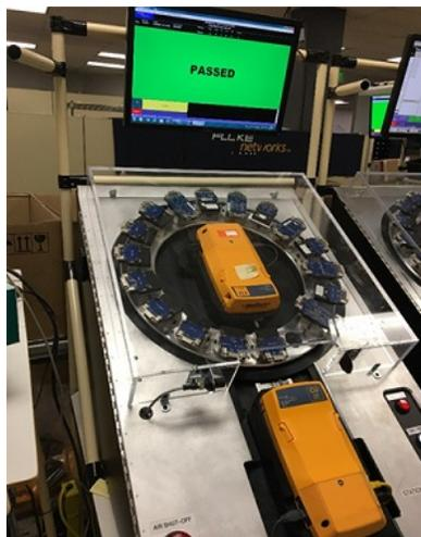
図 1 - メタル線校正ステーション。カスタム設計された 17 機のアーチファクトを Versiv ユニットに順番に接続して、校正を行います。自動回転設定は、生産量に対応するために工場のみで使用されます。
