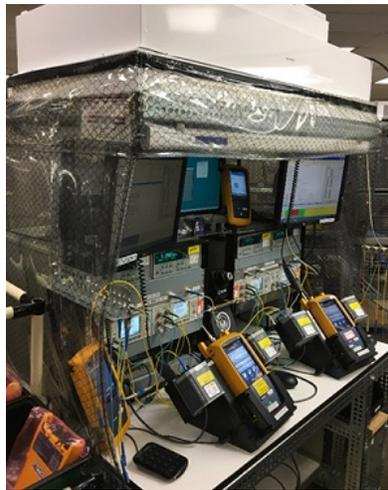
図 2 - 光ファイバー校正ステーション。埃を低減するために、ステーション上部のフィルター・システムにはスチック製カバーが使用されています。フルーク・ネットワークスでは、当社の正確性要件を満たすために、市販製品の一部を変更して使用しています。
