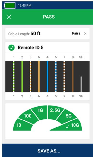
リモート接続をしてケーブル・テストを行うと、各ワイヤーのリモート ID 番号5、長さ、ペアリング、および最大 10Gb/秒のケーブル・パフォーマンスが表示されます。
