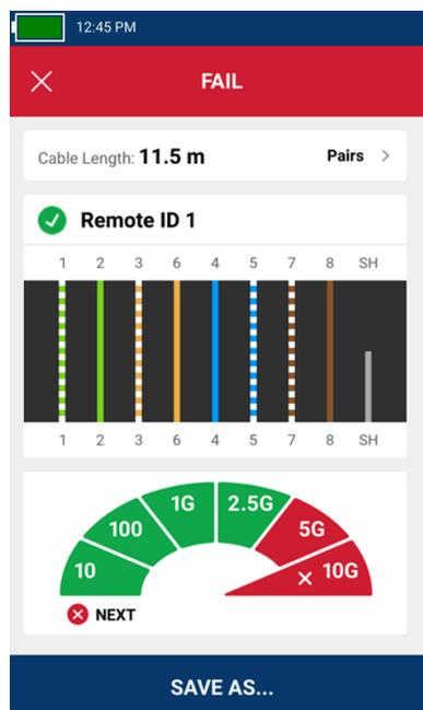
リモート接続をしてケーブル・テストを行うと、各ワイヤーのリモート ID 番号 1、各ワイヤーの長さ、ペアリング、および最大 2.5Gb/秒のケーブル・パフォーマンスが表示されますが、ユーザーが設定した 10Gb/秒パフォーマンス制限のためにテストに失敗しました。
