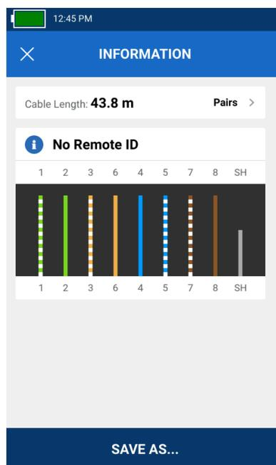
リモート接続せずにケーブル・テストを行うと、各ワイヤーの長さとペアリングが表示されます
