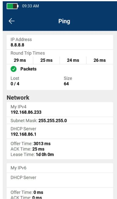
Ping 結果画面には、4つの Ping のそれぞれに対するターゲットへの応答時間が表示されます。下にスクロールすると、DHCP、DNS、ゲートウェイ情報が表示されます。
