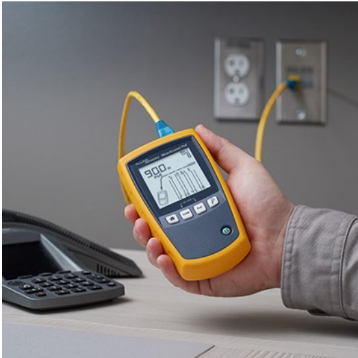
図 5. MicroScanner PoE は Ethernet Alliance Gen2 PoE 認定を受けており、PSE の供給電力、およびネットワーク速度も検出し、一連のケーブル・テスト機能を搭載しています。
