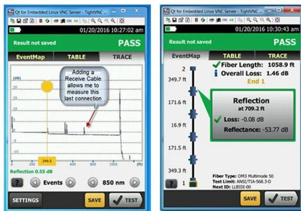
図 5. ランチ・ファイバーおよび受信ファイバーをケーブル遠端に追加することで、OTDR を使ってリンクの最初と最後の接続の損失を測定することができます。
