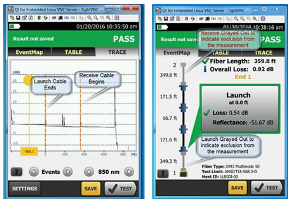
図 6. トレースには、テスト対象のリンクの始まりと終わりの部分のランチ・ファイバーおよび受信ファイバーが含まれます。右側に表示されている EventMap は、ランチ補正によってテスト結果からその影響を取り除きます。
