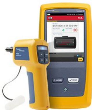
図 2b：フルーク・ネットワークス FI-500 FiberInspector™ Micro のディスプレイおよびプローブ
